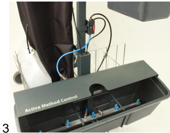
Koppla den högra lösa slangen från ventilhuset i mitten och koppla sedan den blå och svarta sprayslangen mot respektive ramp.
