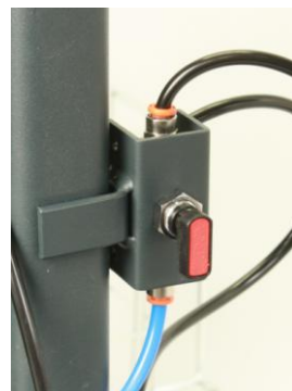
Omkopplare i detta läge aktiverar den korta sprayrampen
